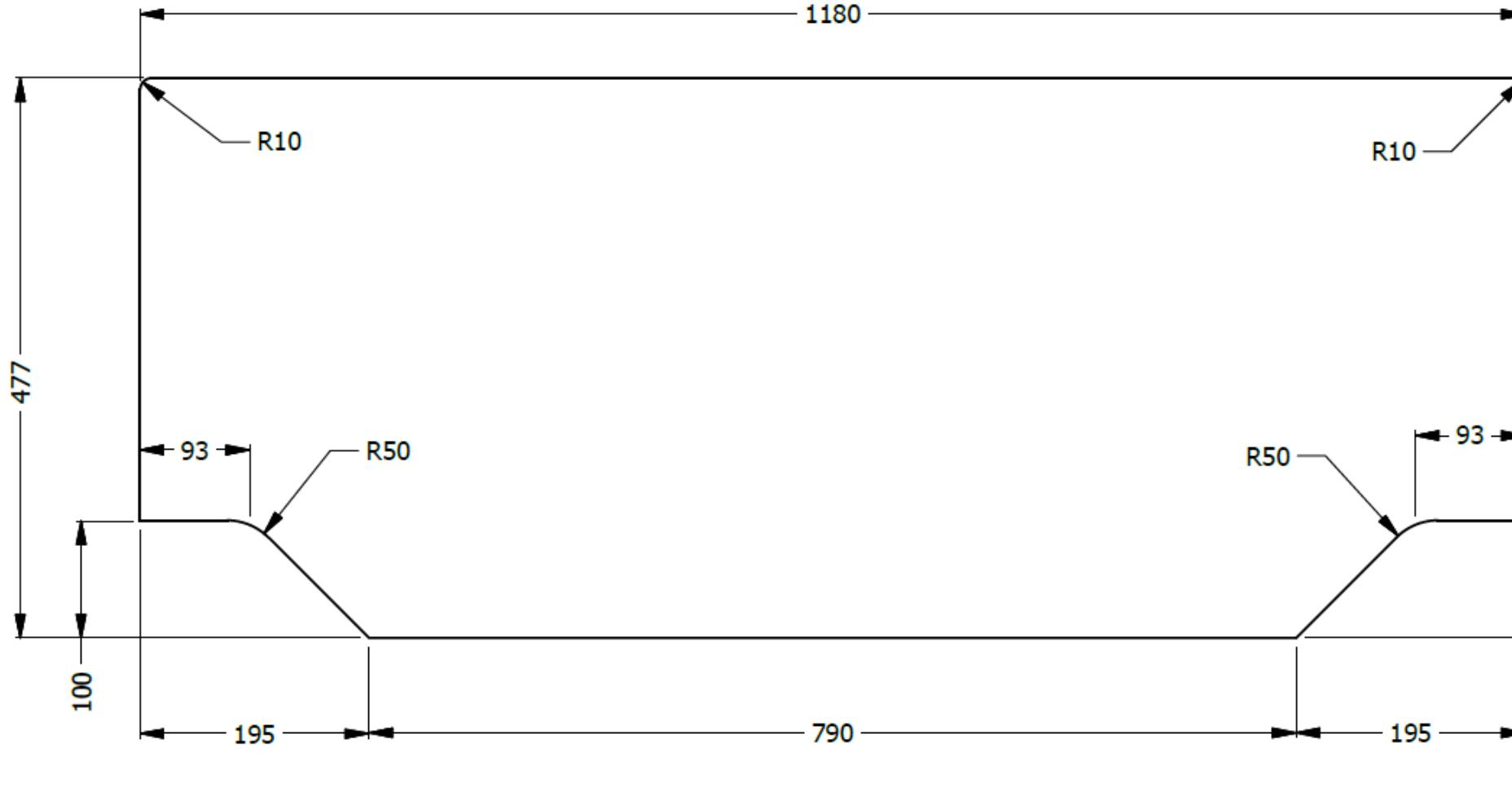
PANTALLA VIDRIO LAM. 3+3 PARA DUCTO DOBLE DE 1,20x0,38 DE ALTURA SOBRE SUPERFICIE CON CAJA
