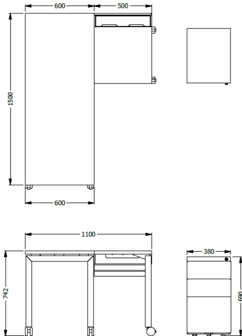
PUESTO DE TRABAJO EN L CON SUPERFICIE PRINCIPAL DE 150X60 Y RETORNO DE 90X50 CON FALDA EL PUESTO DEBE SER MOVIL CON RODACHINAS CON SEGURO Y CON LA RESPECTIVA CAJONERA 2X1 CON RODACHINAS
